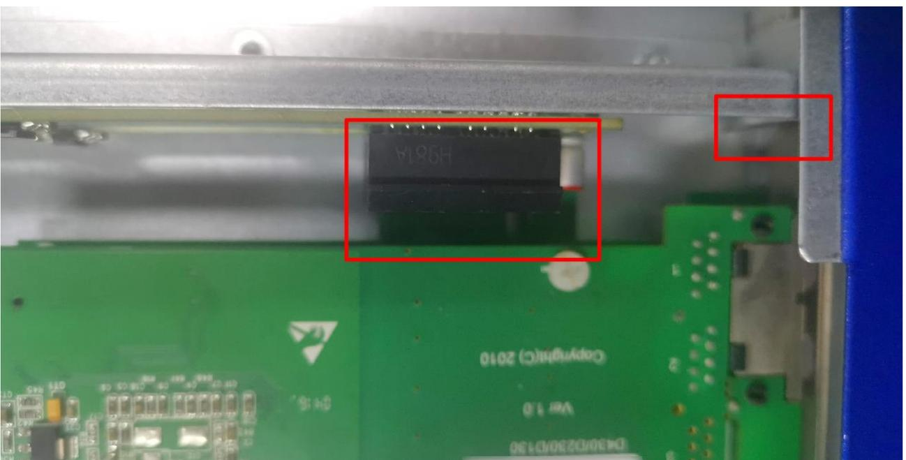
里面的板卡装好后，将挡板装上，螺丝拧紧。
