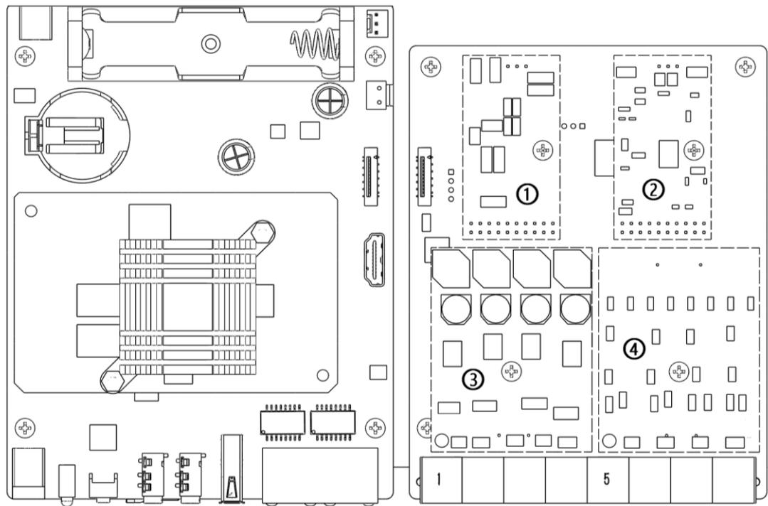
取下模块固定处螺丝，安装模块。
