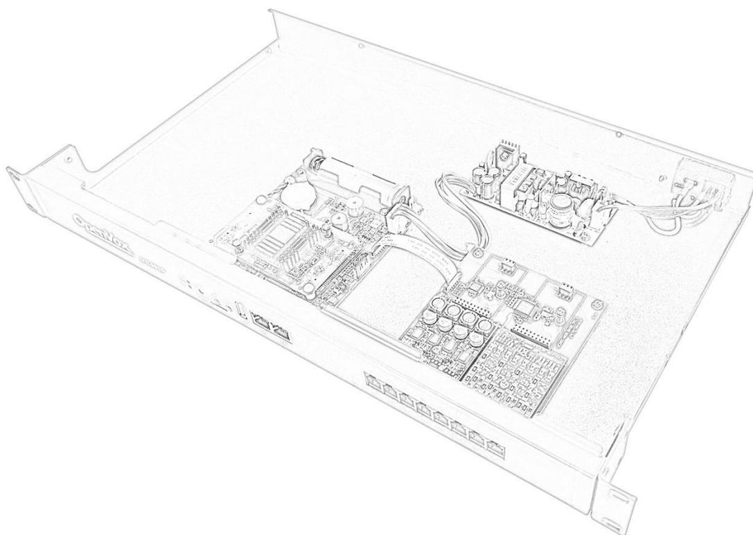
4) 安装完模块，按如图所示方向将机箱垂直插入，与上壳扣合，然后旋紧螺丝。
