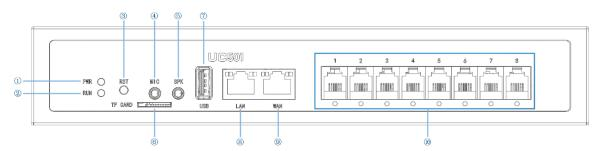
①电源指示灯 ②系统指示灯 ③重置按钮 ④麦克风接口 ⑤音频接口 ⑥TF卡槽 ⑦USB接口 ⑧WAN □ ⑨LAN □ ⑩FXO/FXS接□
