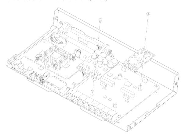
4. 安装完模块,按如图所示方向将机箱垂直插入,与上壳扣合,然后旋紧螺丝。
