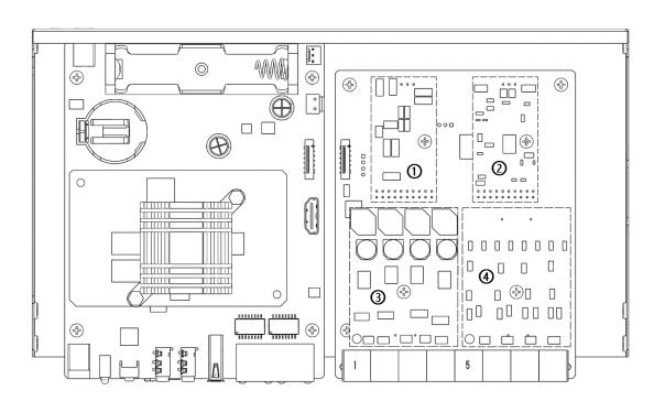
取下模块固定处螺丝,安装模块(②+③)。
