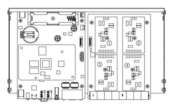
取下模块固定处螺丝,安装模块。
